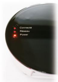
Les diodes rouges « connecté » et « power » se trouvant sur le côté gauche du récepteur s'allument et restent fixes tandis que la diode rouge « Réseau » clignote.
